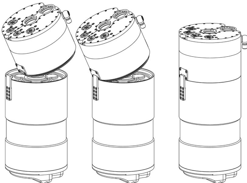
Прикрепите головку к канистре, сначала надевая более широкое отверстие замка головки на стопорный рычаг канистры. Нажмите на головку рукой, чтобы не было видимого зазора между головкой и канистрой.
