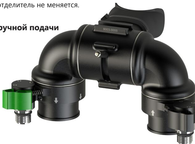
Клапаны для ручной подачи кислорода и дилуента расположены рядом с мундштуком для лучшей эргономики и интуитивно понятного управления. Клапан для кислорода имеет ограниченный поток, чтобы предотвратить подачу высокой дозы кислорода на глубине.
