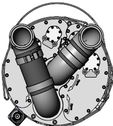
Подсоедините короткий соединительный шланг с коленчатыми патрубками к головке. Патрубки отмечены согласно их местоположению:
