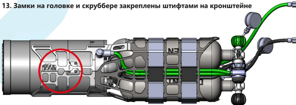
Поместите корпус ребризера в кронштейн так, чтобы оба штифта на кронштейне вошли в отверстия головки и канистры. **Этот шаг имеет решающее значение. Из соображений безопасности необходимо тщательно проверить, чтобы оба штифта вошли в оба отверстия, и чтобы возможность отсоединения головки была полностью исключена. Отсоединение головки и канистры вызовет затопление со смертельным исходом.**
